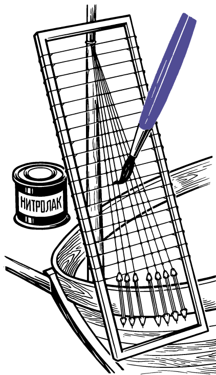
Рис. 19. Рамка-кондуктор для изготовления вантов.
